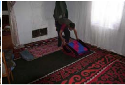
Chłopaki ścielą wyra. Na podłodze leży w charakterystyczne wzory wełniane (z baraniej wełny) coś na wzór dywanu. To takie pledy. Tu nie ma fundamentów, podłoga leży bezpośrednio przy gruncie, a często jest poprostu klepiskiem (jak w jurtach). Te "dywany" grube na 2-4mm, wieszane również na ścianach spełniają rolę ocieplenia. I spełniają tę rolę znakomicie
